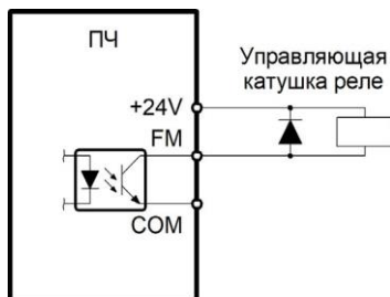
Рисунок 3.18 – Подключение к цифровому выходу с использованием внутреннего источника питания
